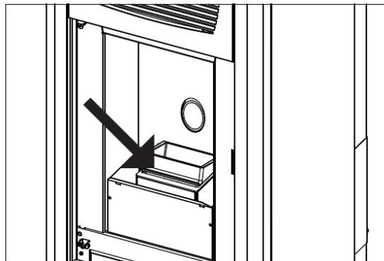
Fig. 26 - Die Brennschale kontrollieren
