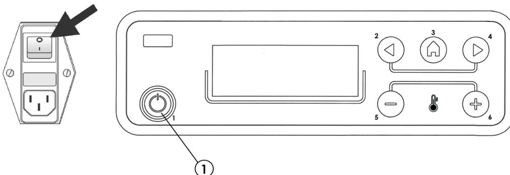
Fig. 27 - Schalter und Display
