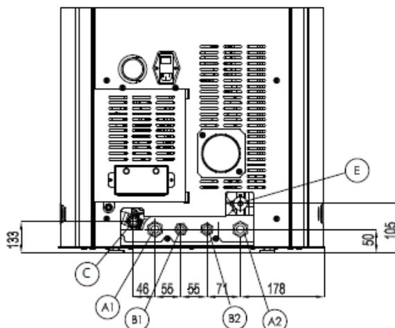
Fig. 19 - WASSERANSCHLÜSSE
