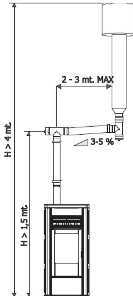
Fig. 3 - INSTALLATIONSBEISPIEL PELLETGERÄT
