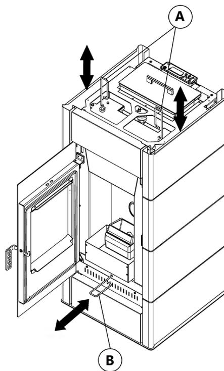
Fig. 40 - REINIGUNG UNTERER KASTEN (Ibis 11 / Idron 11)
