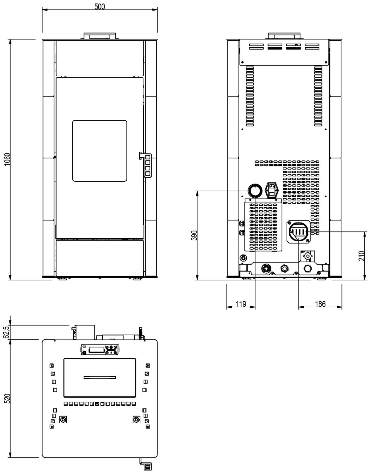
Fig. 9 - ABMESSUNGEN Idron 11
