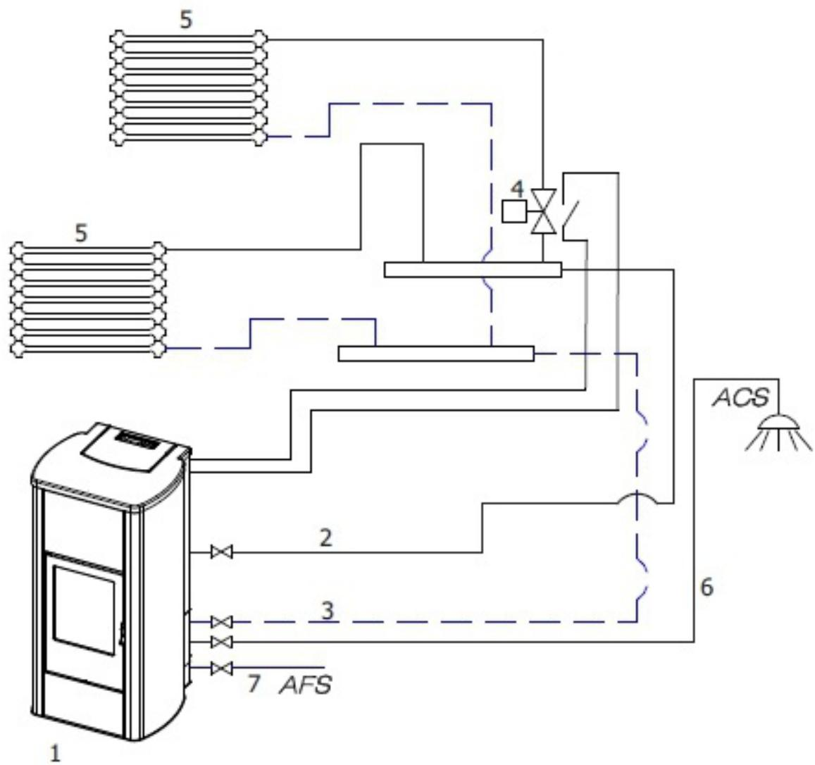
Fig. 30 - KONFIGURATION 2.1 (WERKSEINSTELLUNG VERSION MIT TRINKWASSERERWÄRMUNG - BWW)
