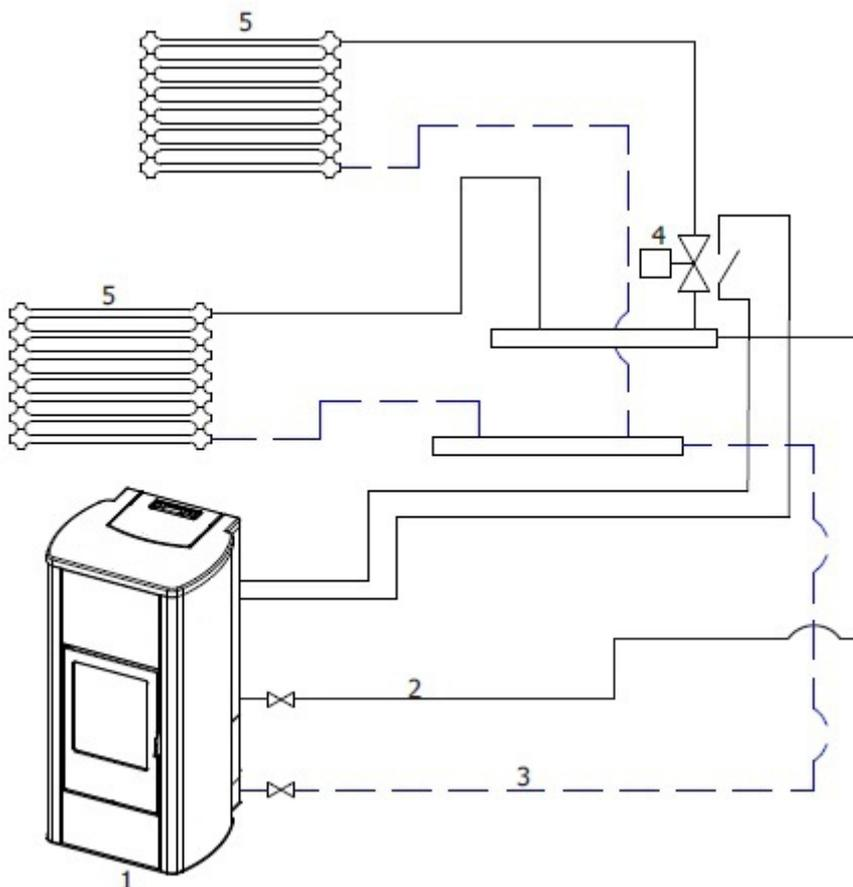
Fig. 29 - KONFIGURATION 1 (WERKSEINSTELLUNG VERSION NUR HEIZUNG)
