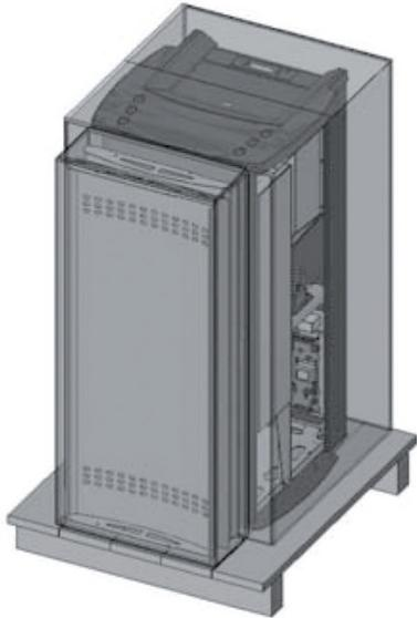
Fig. 11 - BEISPIEL VERPACKUNG OFEN + SEITENTEILE AUS STAHL
