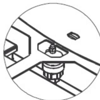
Fig. 23 - ENTLÜFTUNGSVENTIL UNTER DER TOPPLATTE
