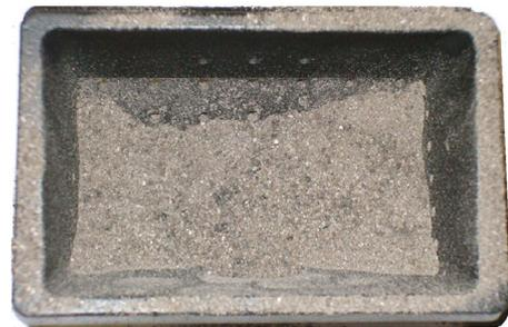
Fig. 38 - BEISPIEL VERSCHMUTZTE BRENNSCHALE
